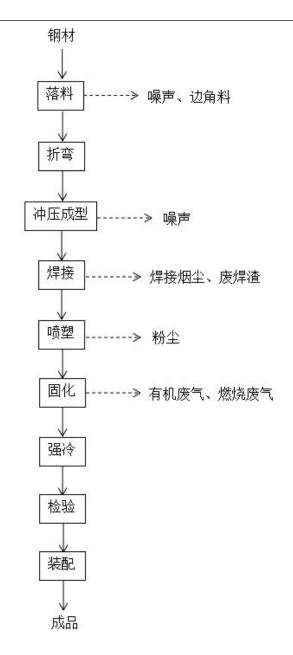
图 1 割草机、旋耕机、碎木机生产工艺流程图
