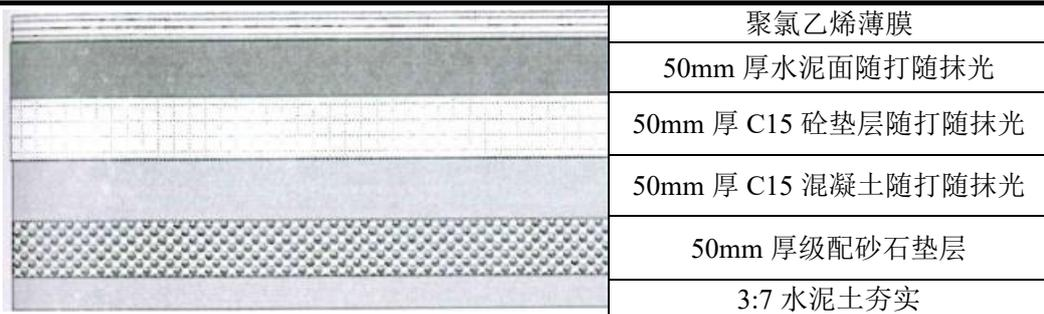
图 4-4 危废仓库防渗结构示意图
