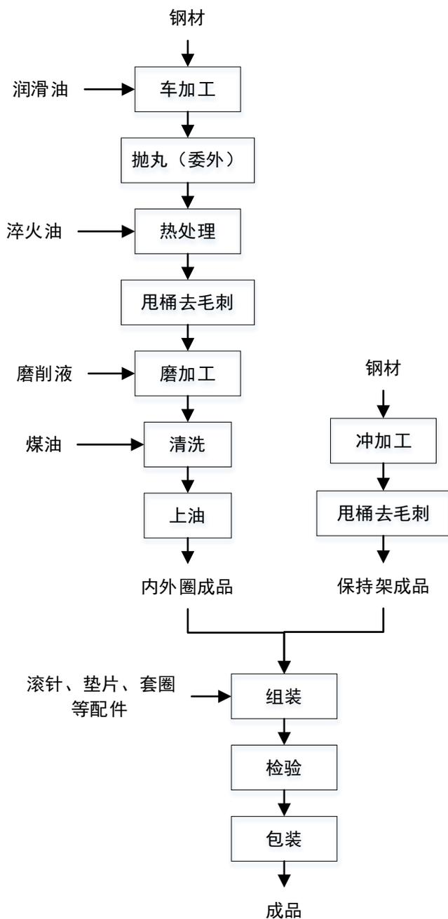
图 2-2 轴承工艺流程图
