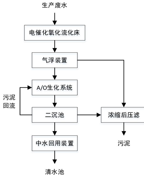
图 4-2 本项目废水处理工艺流程图
