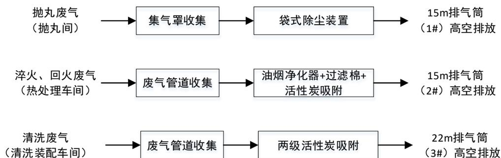
图 4-1 本项目废气处理工艺流程图
