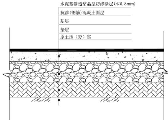
图 4-3 装置区地坪防渗结构示意图
